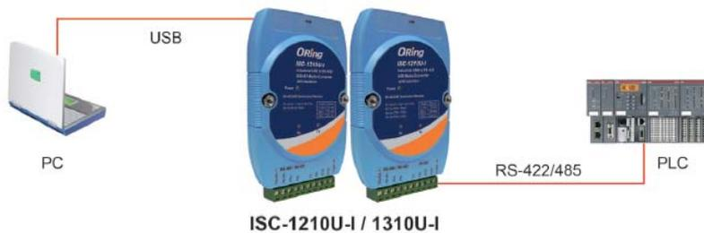
USB 转串口转换器连接示意图
